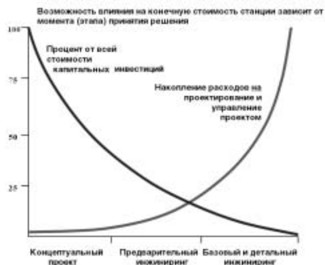
Рис. 3. Влияние времени принятия решения на конечную стоимость АЭС [7, с. 4]
