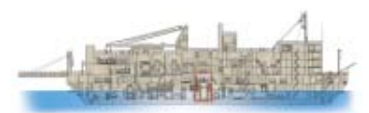
Плавучая АТЭС малой мощности с РУ КЛТ-40С. Мощность реакторной установки 150 МВт. Мощность для потребителя: электрическая – 70 МВт, тепловая – 140 Гкал/ч.
