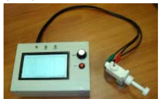
Рис. 6. Прибор, разработанный ЦНИИ КМ «ПРОМЕТЕЙ», для определения химической стойкости (сенсibilизации) нержавеющей сталей
