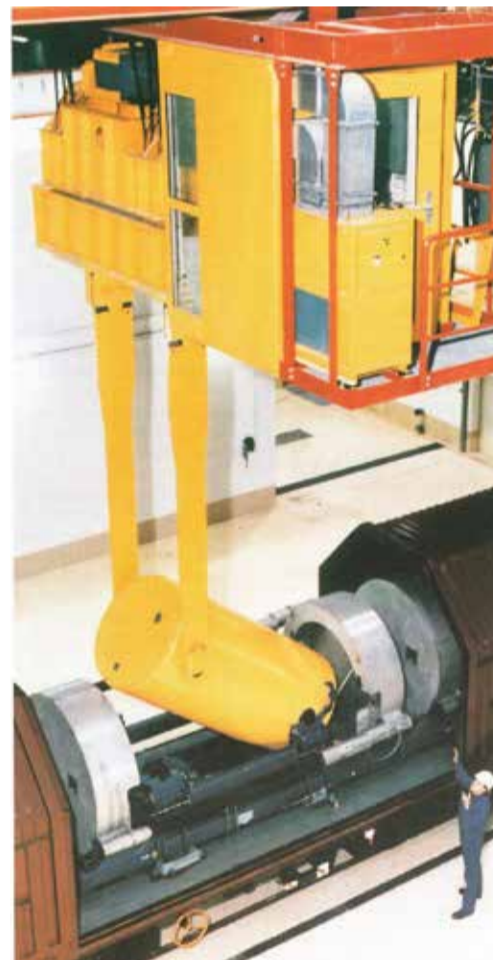
Рис. 12. Установка контейнера в вагон с помощью штатного крана
