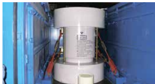
Рис. 14. Натурная модель контейнера для ОТВС исследовательских реакторов
